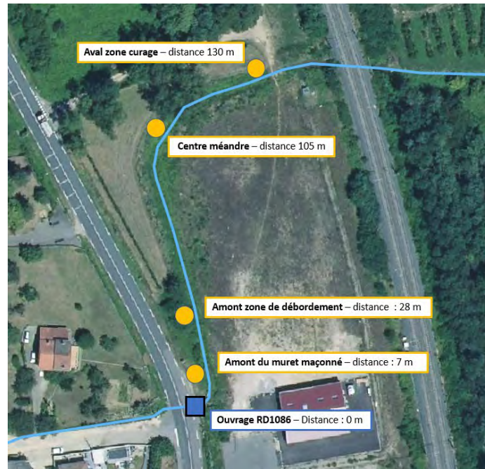
Figure 17 : Localisation de l'implantation des repères avec cotes d'intervention
